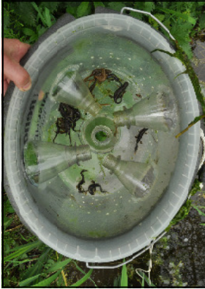
Ein selbstgebaute Molchbreuse. Die Molche schwimmen durch die Öffnungen in den Eimer. Nach der Kontrolle werden sie unversehr wieder frei gelassen.
